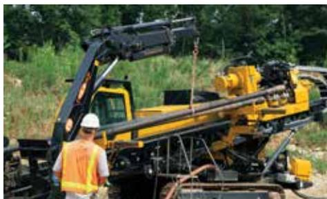
**GRUE À FLÈCHE ARTICULÉE.** La grue à flèche articulée en option, montée de part et d'autre de l'embase d'ancrage manœuvre facilement les outils lourds, ce qui allège les besoins en équipements de soutien.
