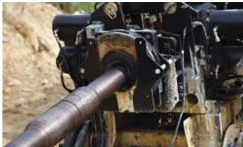
**ÉTAU.** L'étau coulissant se déplace de 89,9 cm pour permettre aux opérateurs de le positionner de manière optimale pour le forage ou le tirage.
