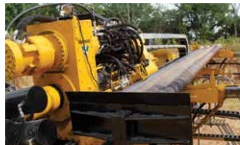
**CHARGEUR DE TIGES.** Un chargeur de tiges à bras coulissant, sur une seule rangée, permet la mise en place de cinq tiges en même temps, ce qui améliore l'efficacité du forage et minimise le temps de chargement des tiges.
