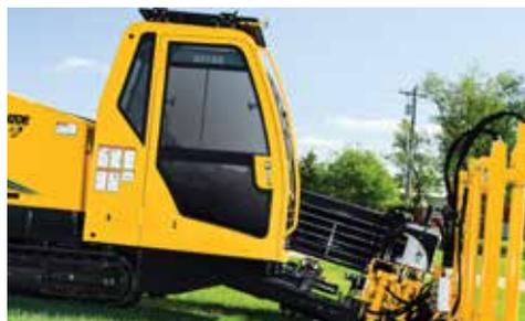
**UNE CABINE CONFORTABLE.** La cabine de type excavatrice offre un plus grand espace pour les jambes et un plus grand confort aux opérateurs.
