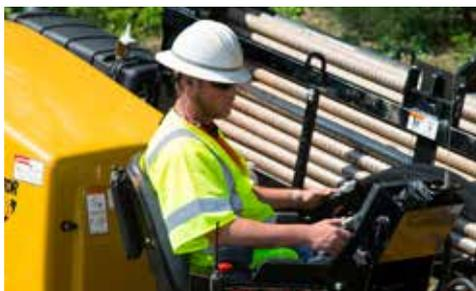
**DIMINUTION IMPORTANTE DU NIVEAU SONORE.** Avec un niveau sonore garanti de 104 dB(A) et une exposition sonore pour les opérateurs de 82,9 dB(A) et, de 75,7 dB(A) à l'intérieur de la cabine, la D24x40 S3 contribue à un environnement de travail plus silencieux, à moins de nuisances pour le voisinage et à une meilleure communication au sein de l'équipe.
