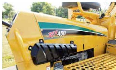
**UNE DIFFÉRENCE DE RENDEMENT.** Constatez par vous-même la différence de rendement, grâce à l'augmentation de 14 % de la puissance (comparée au RT450) apportée par le moteur Tier 4 Final ou Interim, qui vous permet également de répondre aux exigences locales sur les émissions.
