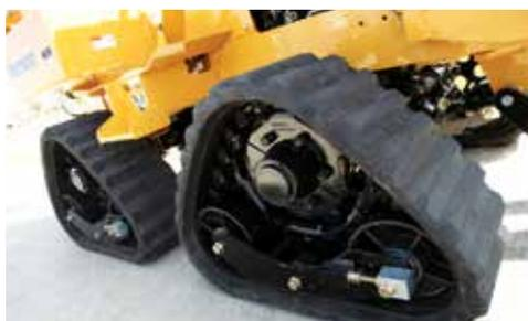
**RÉPONDRE AUX EXIGENCES DU TERRAIN.** Choisissez la configuration qui répond le mieux aux exigences spécifiques de votre chantier, en optant soit pour une option de trains de roues de 66 cm de résistance standard, soit pour les options de trains de roues haute résistance à quatre chenilles motrices exclusifs de 73,7 cm.
