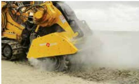
**OUTIL D'EXCAVATION EN SURFACE TERRAIN LEVELER®.** La T1155III est équipée d'une option outil niveleur de terrain entraîné par chaîne pour les applications d'excavation de roche de taille importante, y compris l'exploitation à ciel ouvert, l'évacuation du mort-terrain, la préparation des sites et la démolition des routes.
