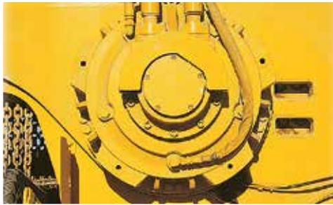
**MOTEUR D'ENTRAÎNEMENT DE TRANCHEUSE À PUISSANCE ROTATIVE.** Un moteur d'entraînement de tranchée à puissance rotative et un arbre de commande cannelé permettent de développer une vitesse inférieure et un couple supérieur qui assurent une meilleure pénétration au sol et une faible usure de chaîne, pour une plus grande productivité.
