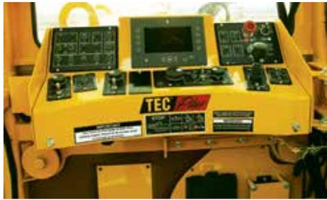
**SYSTÈME DE COMMANDE ÉLECTRONIQUE TEC® PLUS.** Le système d'exploitation communique avec de multiples modules de commande situés sur toute la machine pour obtenir des données de performance en temps réel et effectuer des recherches de panne avancées.
