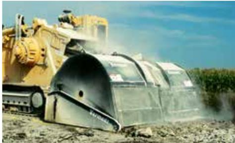
**OUTIL D'EXCAVATION EN SURFACE TERRAIN LEVELER®.** La T955III est équipée d'une option outil niveleur de terrain entraîné par chaîne pour les applications d'excavation de roche de taille importante, y compris l'exploitation à ciel ouvert, l'évacuation du mort-terrain, la préparation des sites et la démolition des routes.
